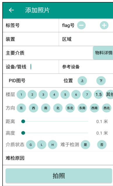
图 3.2.4-1 现场建档时手操器界面示例
